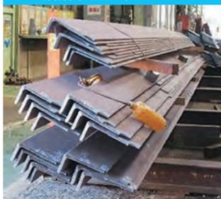
条材の積み上げ高さを極力低くし地震があっても崩れない高さを意識する。
