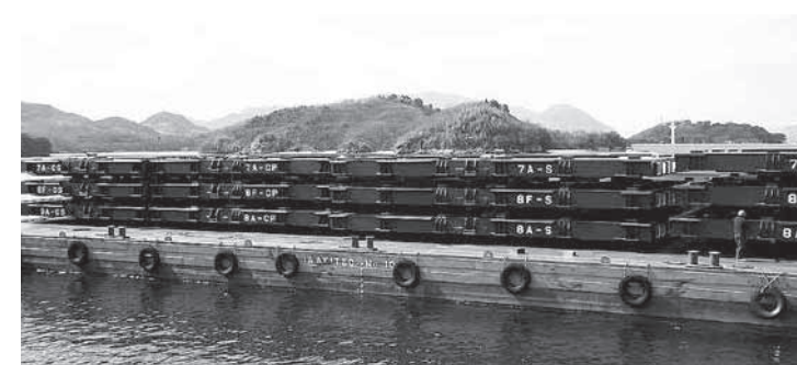
出荷を待つコンテナ船向ハッチカバー（昨年初め製作のもの）
